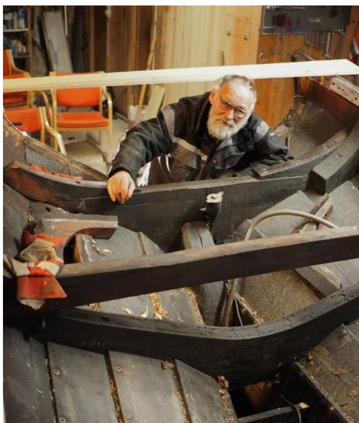
Akterspeilet er teke av og propellakslingen er komen ut. Oddvar Meland ser nøgd ut. Foto: Rebekka Høgestøl.
